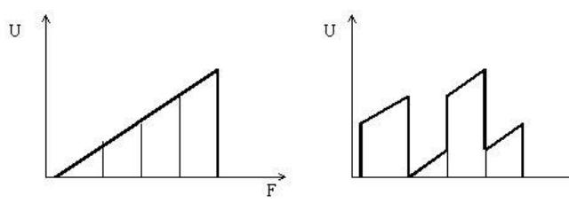
Полосовые скремблеры используют способ разбиения полосы речевого сигнала на несколько поддиапазонов с частотными перестановками этих поддиапазонов. Полосовой скремблер может быть реализован на основе БПФ.
