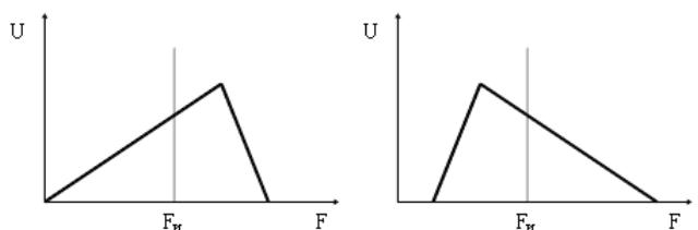
При частотной инверсии преобразование спектра речевого сигнала эквивалентно повороту частотной полосы сигнала вокруг некоторой средней частоты  $F_i$  — частоты инверсии.
