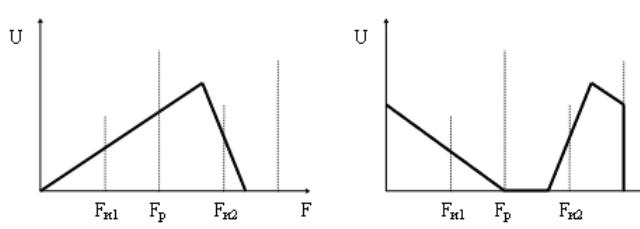
Скремблер с разбиением полосы речевого сигнала на поддиапазоны с частотной инверсией сигнала в каждом поддиапазоне (полосно-сдвиговый инвертор). Обычно используется разбиение полосы на 2 поддиапазона.
