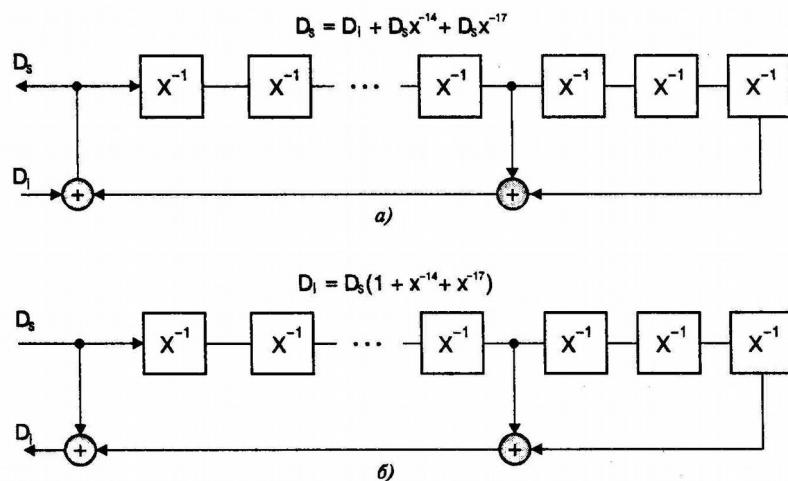
Второй недостаток самосинхронизирующегося скремблера связан с возможностью появления на его выходе при определенных условиях так называемых «критических ситуаций», когда выходная последовательность приобретает периодический характер с периодом, меньшим длины ПСП. Чтобы предотвратить это, в скремблере и дескремблере предусматриваются специальные дополнительные схемы контроля, которые выявляют наличие периодичности элементов на входе и нарушают её.
