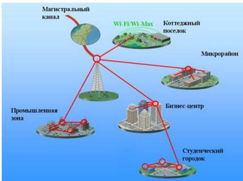
Изделия серии М1 применяются при организации телекоммуникационных сетей интегрированного обслуживания, ЛВС, обеспечении доступа в Интернет, соединении БС сотовой связи, АТС и в других случаях, когда нужно высокоскоростное и экономичное решение для передачи информации между пространственно разнесенными объектами (часто разделенными естественными и искусственными преградами — реками, мостами, эстакадами, автотрассами и т. д.).
