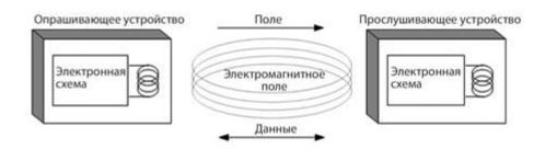
При передаче информации пассивному устройству используется амплитудная манипуляция ASK. При обмене с активным устройством оба устройства равноправны. Каждое устройство имеет собственный источник питания, поэтому сигнал несущей отключается сразу после окончания передачи.
