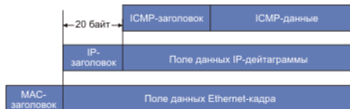
Рис. 4. Схема вложения ICMP-пакетов в Ethernet-кадр
