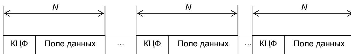
Рис. 2. Структура циклов в асинхронной системе передачи данных
