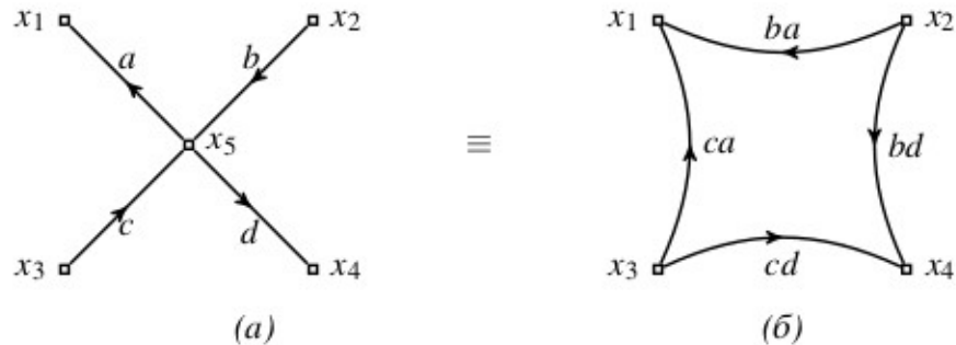
Рис. 8.8. Исключение узла в звезде: (а) исходная звезда; (б) итоговый квадрат
