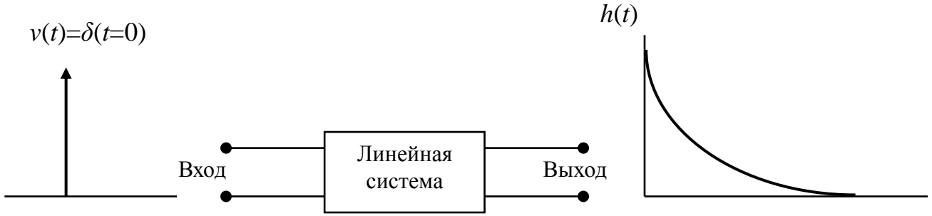
Рис. 1.4. Импульсная характеристика линейной системы h(t)
