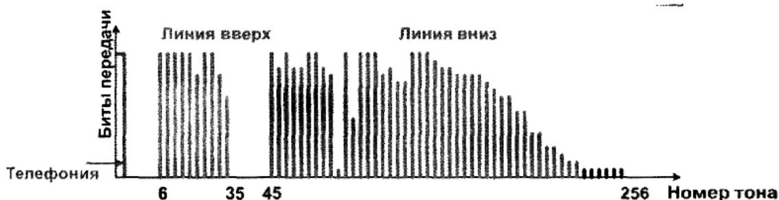
Рис. 2. Дискретная многотоновая модуляция DMT в технологии ADSL.
