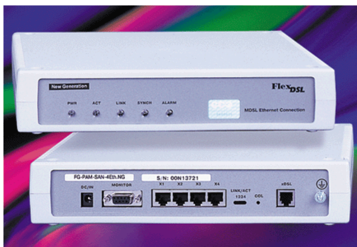
Рис. 2.2. SHDSL-модемы FG-PAM-SAN-4Eth фирмы Nateks
