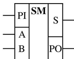
Рис. 2.10. Условно-графическое обозначение полного двоичного одноразрядного сумматора
