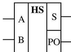
Рис. 2.8. Условно-графическое обозначение одноразрядного полусумматора
