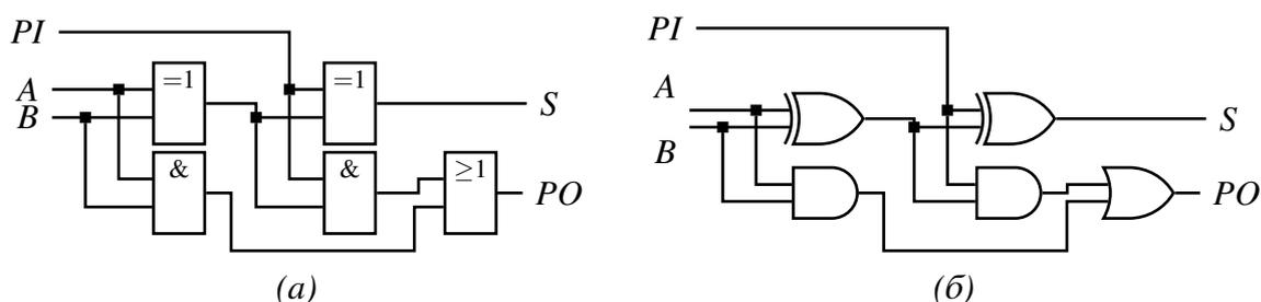
Рис. 2.9. Принципиальная схема полного двоичного одноразрядного сумматора на основе сумматоров по модулю 2:
