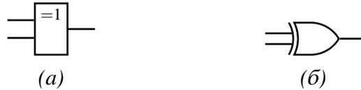
Рис. 2.5. Условно-графические обозначения сумматора по модулю 2: (а) по стандартам IEC и ЕСКД; (б) по стандартам MIL/ANSI и CDH
