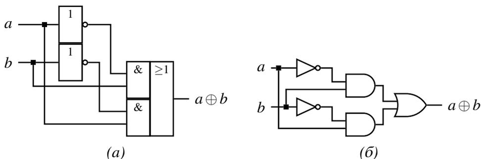
Рис. 2.4. Принципиальная схема сумматора по модулю 2: (а) по стандартам IЕС и ЕСКД; (б) по стандарту MIL/ANSI
