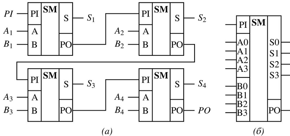
Рис. 2.11. Полный двоичный четырехразрядный сумматор:
