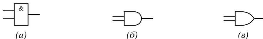
Рис. 2.2. Условно-графические обозначения логического элемента «И»:
