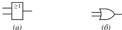
Рис. 2.3. Условно-графические обозначения логического элемента «ИЛИ»: (а) по стандартам IEC и ЕСКД; (б) по стандартам MIL/ANSI и CDH
