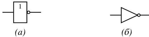
Рис. 2.1. Условно-графические обозначения инвертора:
